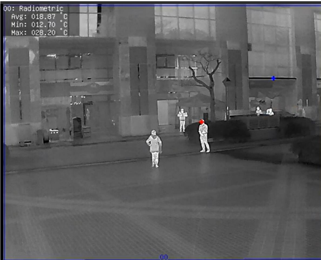
【下圖為 thermal lens 9mm, 可見光 lens 6mm, 攝影機架 3米高, 偵測範圍約 30米*30米】
